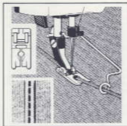
411 85 00-01. Voet voor het opnaaien van soutache. Het koord door de geleider voeren en met een rechte naad midden op het koord vastnaaien.
